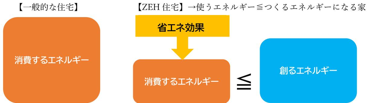
住宅の高気密・高断熱化に加え、省エネ設備機器、HEMS、太陽光発電システムなどを組み合わせ、さらにエネルギー消費を上回るエネルギーを自宅で発電し、エネルギー収支をゼロ又はプラスにする住まいのこと。
